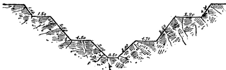
FIG. 13. — Coupe transversale montrant la disposition suivie dans le dégagement et l'établissement de la Seguia de l'Aïn Bordj-ben-Briji.
