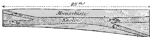
Fig. 91. — Coupe horizontale de la carrière de Saint-Bonnet.
