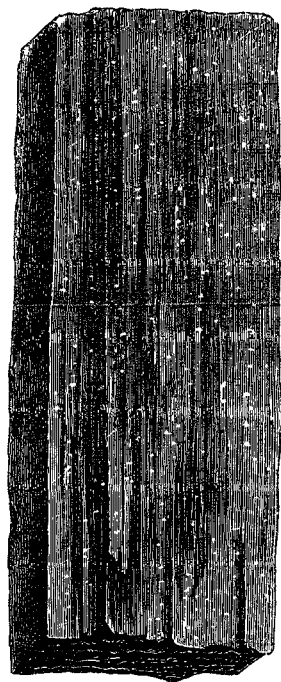
Fig. 92. — Développement de la structure schisteuse, dans une argile mélangée de mica et soumise à un écoulement; le feuilleté est ici parallèle au sens de la pression. Cassure perpendiculaire aux feuillets — Grandeur naturelle
