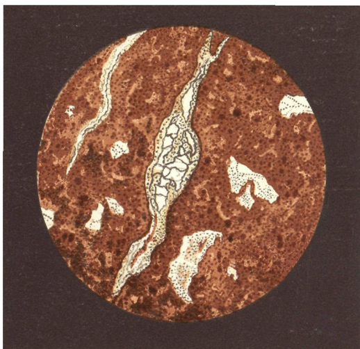
Fig. 19. — Brique zéolithique coupée en tranche mince et montrant l'opale ordinaire et l'hyalite, déposées dans les pores par les eaux thermales de Plombières; grossissement de 180 diamètres.
