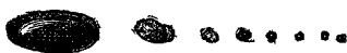
Fig. 155. — Anthracite obtenue dans la décomposition du bois, et granulée par l'eau suréchauffée; la forme de ces globules annonce que la substance a nécessairement passé par un état de ramollissement. — Grandeurs naturelles.
