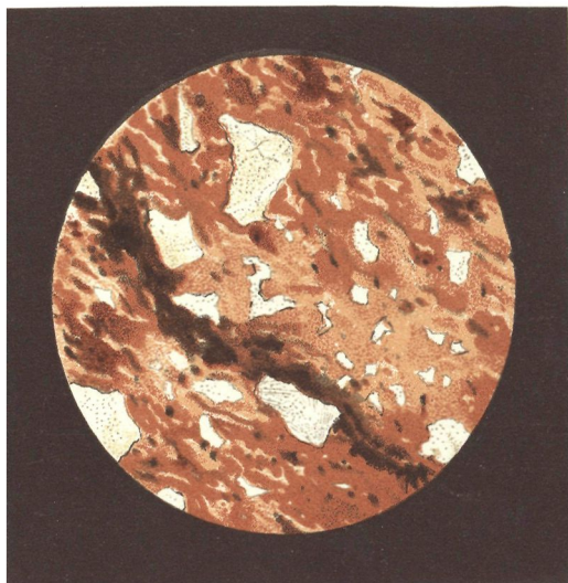
Fig. 24. — Brique romaine de Plombières, réduite en tranche mince, ne présentant aucun minéral déposé par l'eau thermale. La structure fluidale y est caractérisée. Grossissement de 150 diamètres.
