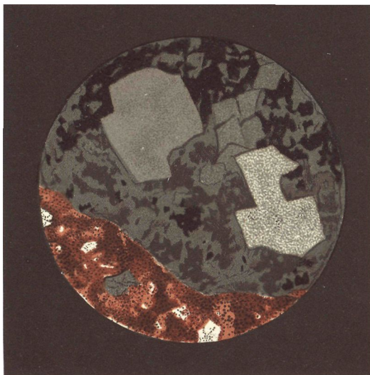
Fig. 21. — Brique zéolithique réduite en tranche mince, montrant l'opale et une zéolithe de forme rhomboédrique (chabasite?) déposée dans les cavités par l'eau thermale de Plombières. Grossissement de 600 diamètres.
