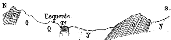
Fig. 72. — Coupe représentant la disposition d'une masse de quartz Q avec minerai de fer, accompagnée de gypse gy, au contact du granite y et du calcaire crétacé c à Esquerde (Pyrénées-Orientales). — D'après Durocher.
