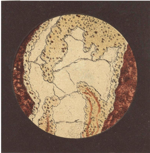
Fig. 20. — Portion de la même brique vue à un grossissement de 600 diamètres.
