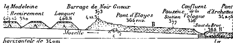
Fig. 3. — Coupe schématique des alluvions de la Moselle entre Remiremont et le Saut du Broc. — Echelle approximative des longueurs : 1 millim. pour 146 mètres.
