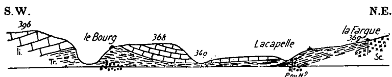
Fig. 2. — COUPE DU BOURG A LA CAPELLE-MARIVAL, montrant la réapparition du grès triasique au Bourg, à la faveur d'un anticlinal et la faille de la Fargue. — Échelles : longueurs, 1/50 000 ; hauteurs, 1/3 000.
