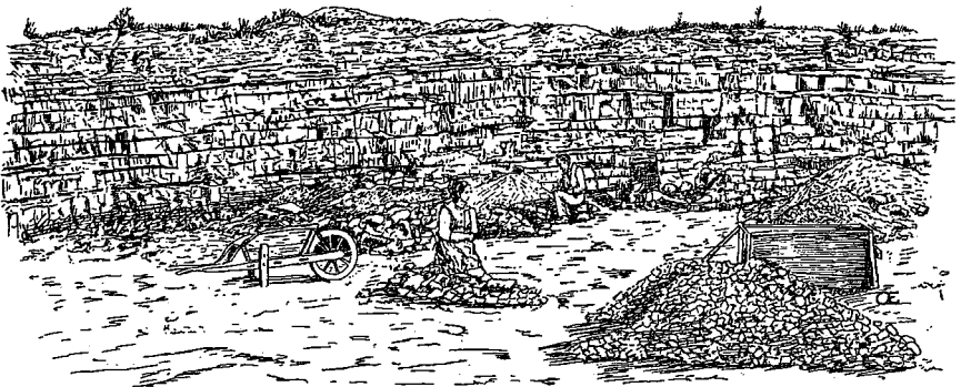
Fig. 13. — CARRIÈRE DE ST-DENIS-D'ORQUES. Grès armoricain exploité pour le macadam, et dont les bancs presque horizontaux décrivent une courbe surbaissée, indiquant la disposition en dôme qui réapparaît plusieurs fois et caractérise la limite sud de cette bande de grès, aux environs de St-Denis-d'Orques.
