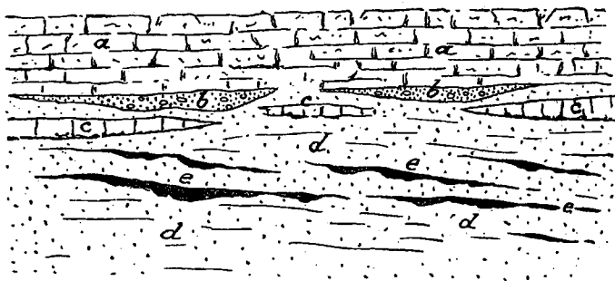
Fig. 5. — a , Calcaire marneux à Limnées et Planorbis; b b' , Poches argileuses avec grosses Limnées brisées; c c' , Lentilles calcaires avec les mêmes fossiles; d , Sable argileux jaunâtre avec filets ligniteux en e .
