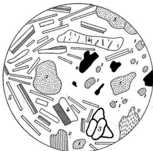
Fig. 12. — Mélange d'argile et de phonolite. — Grossissement : 80 diamètres.
