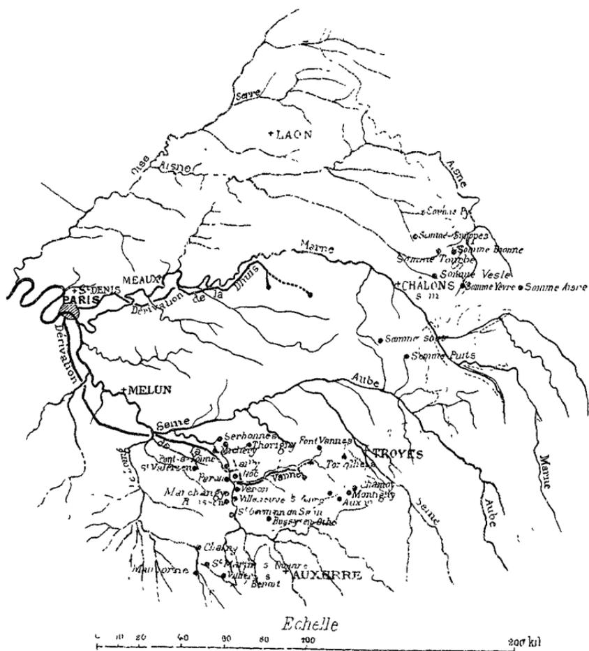
Fig. 96. — Carte montrant la disposition de quelques-unes des principales sources jaillissant des plateaux crétacés dans le N.-E. de la France, ainsi que celles de la Dhuys qui sourdent du terrain tertiaire.
