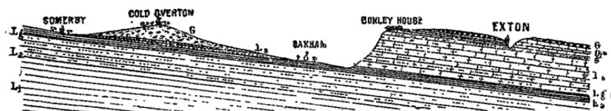
Fig. 116 — Coupe prise dans le Rutland (Lincolnshire) de Somerby à Exton, montrant les deux niveaux d'eau soutenus par les argiles marneuses et supérieures du lias, sur une longueur de 16 kilomètres; G, boulder clay, O, oolithe inférieure; Ls, argile du lias supérieur, Lg, *marlstone rock bed*; La, sables et argiles du *marlstone*, Li, argile du lias inférieur. — D'après M. Judd.
