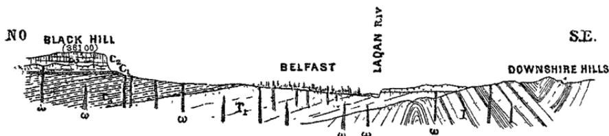
Fig. 128. — Coupe montrant la disposition des eaux souterraines à Belfast et environs. I, silurien inférieur où l'eau est fournie par des puits; T<sub>1</sub>, grès bigarré (new red sandstone) dont l'eau alimente aussi de nombreux puits; T<sub>3</sub>, marnes irisées (keuper); C<sub>1</sub>, grès vert supérieur (upper green sand); C<sub>2</sub>, craie, ω, basalte en nappes et nombreux dykes et pointements; G, graviers quaternaires. — D'après une très obligeante communication de M. Edward Hull.
