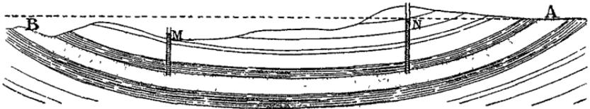
Fig. 84 — Coupe d'un groupe de couches disposées en forme de bassins parmi lesquelles il en est une AB perméable comprise entre deux couches argileuses. MN, niveau auquel l'eau s'élève dans deux frages, exécutés à des altitudes différentes (d'après M. Callon).
