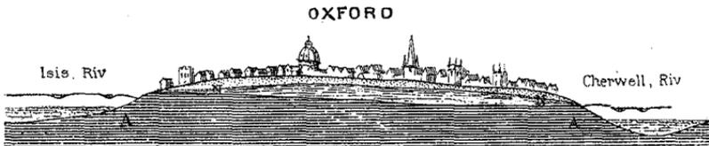
Fig. 21. — Coupes du sol de la ville d'Oxford, montrant la disposition de la nappe phréatique N N, dans le gravier que supporte l'argile A, dite d'Oxford.
