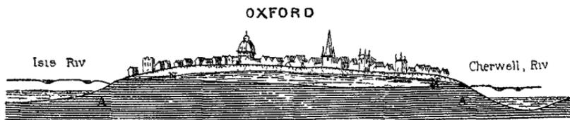
Fig. 42. — Coupe montrant la situation du dépôt quaternaire, auquel est subordonnée la nappe d'eau phréatique d'Oxford. A, argile dite d'Oxford; NN, niveau de la nappe phréatique.
