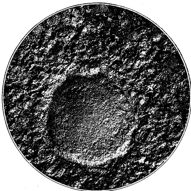
FIG. 1. — REPRODUCTION D'UN CIRQUE LUNAIRE AU MOYEN D'UN ALLIAGE FUSIBLE.
