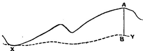
Fig. 38. — Coupe verticale théorique, montrant la disposition relative du niveau hydrostatique XY et de la superficie XA, dans le cas simple de terrains homogènes.
