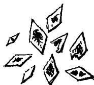
FIG. 4. — RHOMBOÈDRES DE DOLOMITE (CALCAIRE SAHÉLIEN D'ORAN) COLORÉS AU CHROMATE
