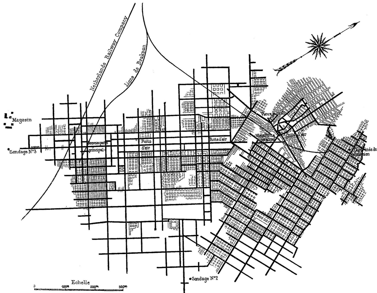
Fig. 14. — Transvaal Coal Trust Cr. Plan de la mine de Brakpan Colliery, montrant l'état d'avancement au 1 er mars 1895.
