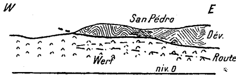
FIG. 6. — CHEVAUCHEMENT DU DÉVONIEN SUR LE WERFÉNIEN A L'AVAL DE SAN PEDRO.
