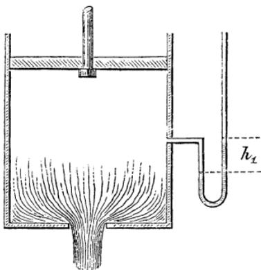
*manomètre à siphon*, et dans lequel une colonne-d'eau ou de mercure indique, par sa dénivellation, l'excès ou ce que l'on nomme la *hauteur de pression*.
