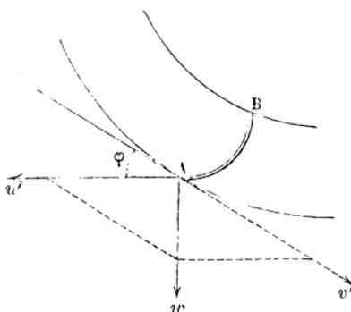
$v'$  étant la vitesse de la palette au point A de sortie ;  $\angle p$  l'angle compris entre  $u'$  et le prolongement de la direction de  $v'$  ; la vitesse absolue de sortie sera
