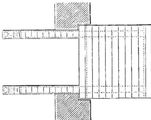
inférieur de la porte, et de pratiquer un aussi grand vide en arrière de ses pieds-droits. Quant à la manœuvre, elle s'effectue, soit à la manière des ponts-levis à flèches ordinaires, en faisant agir les hommes à l'extrémité de la bascule, au moyen de petites chaînes, soit en les faisant opérer de la partie supérieure même du plancher, au moyen de longues perches de bois, ainsi que cela se pratique à Metz, au pont-levis cité de la porte des Allemands.
