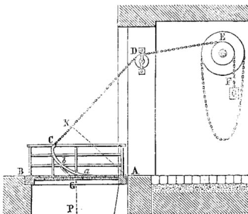
une seconde poulie E, placée en arrière et montée sur un arbre de manœuvre horizontal, en bois ou en fer; à l'extrémité F de cette chaîne pendrait immédiatement le contre-
