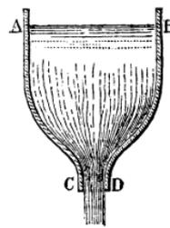
la paroi qui porte l'orifice aurait (*fig. 8*) exactement la forme que tend à prendre la veine fluide, c'est-à-dire serait terminée par un raccordement de cette forme, la contraction serait évidemment la plus petite possible ou nulle, de sorte que les filets sortiraient de l'orifice dans des directions très-sensiblement parallèles.
