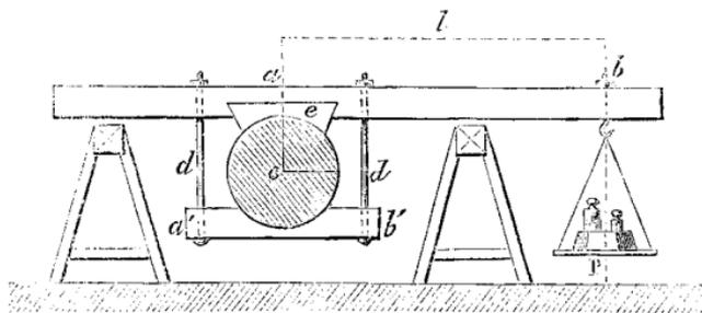
qui repose sur l'arbre tournant *c*, auquel la direction du levier est perpendiculaire. Une autre pièce *a'b'*, placée sous
