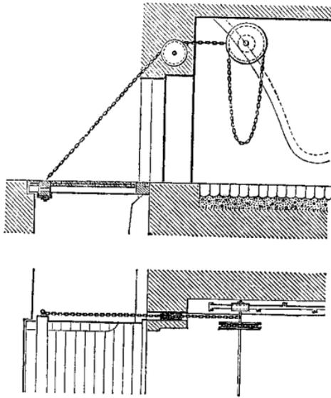
fin de l'ascension du tablier, les chaînes des poulies de manœuvre pendent à terre dans la boue des ruisseaux qui accompagnent la chaussée du passage et diminuent d'autant le poids des rouleaux; 2° que les hommes sont obligés, à ce même instant, d'abandonner ces chaînes pour s'appliquer, d'une manière assez désavantageuse, aux poulies ou à l'axe du treuil; 3° que la manœuvre présente tout autant de danger que celle du pont-levis à flèches, puisque, une chaîne du pont venant
