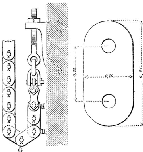
La distance entre les branches verticales d'une même chaîne doit être d'au moins  $0^m,04$ ; et, pour réduire les dimensions des plaques et boulons à celles ci-dessus dans le cas de forts tabliers, il est convenable d'accoupler deux chaînes  $ag$ ,  $a'g'$  (*fig. 101*) semblables aux précédentes, sous une même
