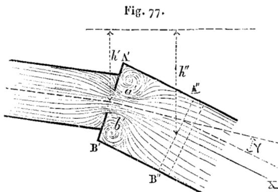
plaque percée d'un orifice de section  $\omega'$ ;  $m'$  le coefficient de contraction. La section contractée  $a'b'$  sera  $m'\omega'$ .
