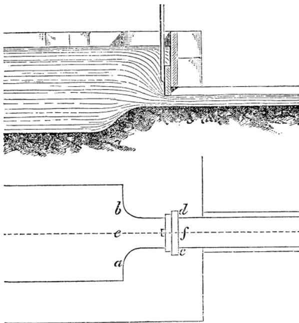
Les choses étant ainsi disposées, la contraction se trouvera sensiblement détruite sur trois des côtés de l'orifice, la vitesse à l'origine du coursier sera à très-peu près égale à celle qui est due à la charge génératrice moyenne dans le réservoir, et le coefficient de la dépense aura pour valeur, même dans le cas de charges ou d'ouvertures assez fortes :
