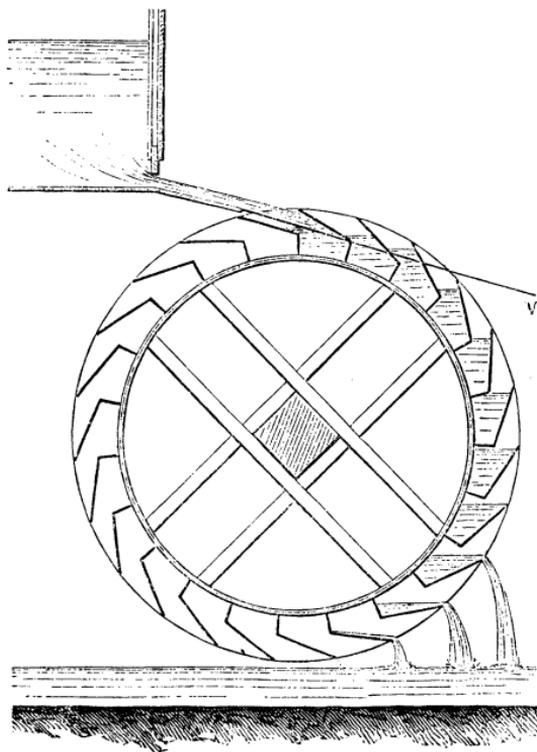
rement vers la partie supérieure, prend la vitesse de la roue et descend, avec les augets qui le contiennent, jusqu'à une certaine hauteur, où son niveau atteint le bord de l'auget. A partir de cette position l'eau commence à sortir et le versement continue jusque vers le bas de la roue. Dans les grandes roues qui marchent lentement, la vitesse avec laquelle le li-
