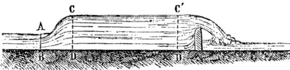
contrainte de s'élever ou de gonfler jusqu'à une certaine distance en amont, à laquelle son niveau se déprime brusquement et forme un *ressaut* avec le surplus du courant, en faisant, dis-je, ce rapprochement, M. Bélanger en conclut que la formule ci-dessus représente d'une manière satisfaisante les différentes circonstances du phénomène.
