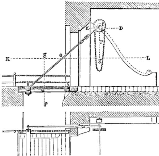
d'équilibre du précédent et même de ceux du pont à sinussoïde de Bélidor, dont il diffère principalement en ce que les rouleaux du contre-poids sont liés au tablier par de grandes barres de fer BC, placées de part et d'autre des montants de la porte, qu'ils traversent au moyen de créneaux pratiqués dans l'épaisseur de ces montants. La manœuvre s'y effectue, d'ail-
