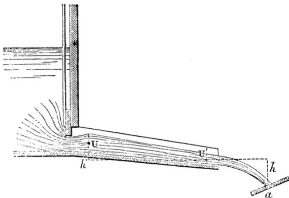
trémité inférieure du coursier; alors on mesurera l'aire  $ii'$  du profil de la lame d'eau vers cette extrémité en un point pour lequel la dépression qui caractérise le déversoir (55) est prête à se manifester d'une manière sensible; ayant d'ailleurs calculé la dépense  $Q$ , qui se fait par l'orifice, d'après les méthodes
