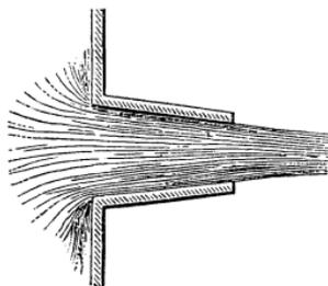
pour les ajutages pyramidaux ou coniques (*fig\* 13*) dont le plus petit orifice serait à une distance de l'orifice intérieur au réservoir comprise entre 1 fois et  $1\frac{1}{2}$  et 3 fois sa largeur, et dont le diamètre ou les côtés seraient respectivement les **0,80** des siens propres.
