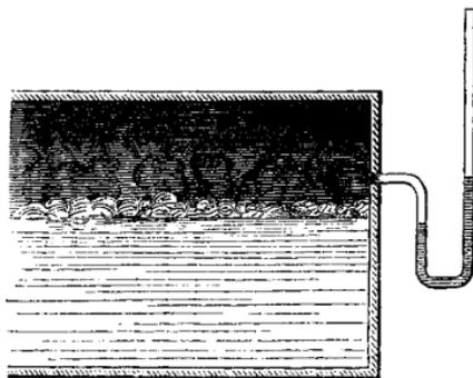
d'un côté et avec l'atmosphère de l'autre, tel que nous l'avons décrit (12, Sect. I). Du mercure versé dans sa partie inférieure indique par sa dénivellation l'excès de pression de la vapeur sur l'air atmosphérique; par conséquent, sachant que 1 mètre cube de mercure pèse 13598 kilogrammes, et nommant  $h$  la hauteur de la colonne de mercure qui mesure la différence de pression, on aura, pour la pression  $p$  sur 1 centimètre carré,
