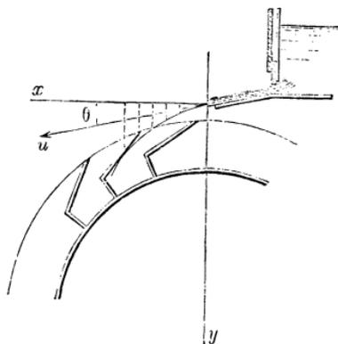
fait sa direction avec l'horizontale et considérons la trajectoire du filet moyen. On aura pour la déterminer, en prenant pour son origine l'extrémité inférieure du coursier et comptant les  $y$  dans le sens vertical et les  $x$  dans le sens horizontal,
