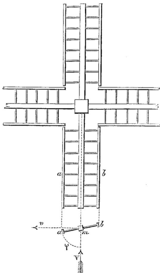
de raison que pour les roues hydrauliques mues par un courant indéfini (64), que la pression dans cette même direction est proportionnelle au poids d'un prisme de fluide ayant  $o$  pour base, et pour hauteur celle due à la vitesse relative  $V \sin \varphi - v \cos \varphi$ , c'est-à-dire
