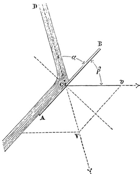
qui se meut avec la vitesse  $v$  dans la direction  $Ce$ , formant avec celle de la palette l'angle  $BCv = \beta$ ; que pareillement le fluide arrive, par filets parallèles, avec la vitesse  $V$  et sous une di-
