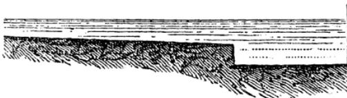
courant d'eau inférieur, dont le niveau général est connu, on aura bien la profondeur d'eau et la section  $O'$  au débouché, mais non pas  $U'$  et  $Q$ , qu'il faudra déterminer par des observations directes, en se reportant, par exemple, à la prise d'eau ou à une partie du courant dont le régime soit sensiblement uniforme et dont la dépense puisse être ainsi jaugée (66).
