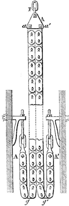
qu'elle est relative au poids et à la largeur que doivent recevoir les chaînes pour satisfaire aux conditions de l'équilibre : par exemple, si la plus petite largeur dans le sens des boulons doit être de  $0^m,27$ , on pourra composer le noyau de trois rangs de plaques de  $0^m,08$  d'épaisseur ou de cinq rangs de  $0^m,05$ , et il restera ensuite à garnir les côtés de plaques qui aient ensemble une épaisseur de  $0^m,03$  ou  $0^m,02$ .
