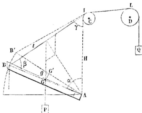
Cela posé, nommons  $\gamma$  l'angle  $AIB$ ;  $\alpha$  et  $\beta$  les angles que  $AB$ , parvenu à une position quelconque, fait avec la verticale  $AI$  et la direction  $BI$  de la chaîne;  $P$  le poids du tablier agissant au centre de gravité  $G$ ; faisons
