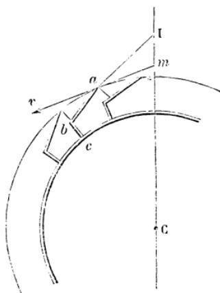
volume d'eau qu'un auget peut recevoir croît avec l'angle  $lam$ , et, par conséquent, son maximum correspond à l'auget supérieur. Aussi, dans la plupart des roues où la vitesse n'est pas très-grande et où le centre  $I$  se trouve en dehors de la circonférence extérieure, on est dans l'usage d'admettre l'eau au sommet de la roue.
