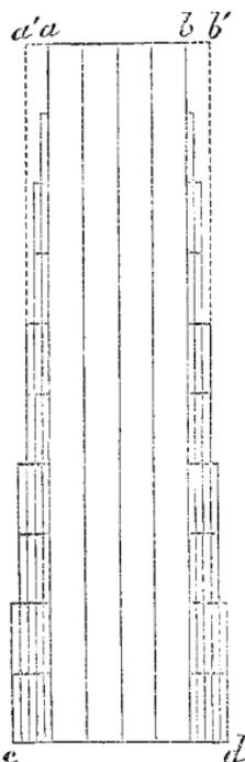
qu'on obtient en ajoutant aux divers boulons des rondelles ou de petites plaques, dont le poids augmente convenablement de l'armature supérieure à l'armature inférieure. Mais on démontre, par les mêmes calculs, qu'en se contentant de donner aux chaînes du contre-poids une épaisseur uniforme  $a'b'$  moyenne entre celles  $ab$  et  $cd$  que doivent recevoir leurs extrémités, d'après l'équation ci-dessus, l'équilibre ne sera nullement troublé pour les positions initiale et finale du ta-
