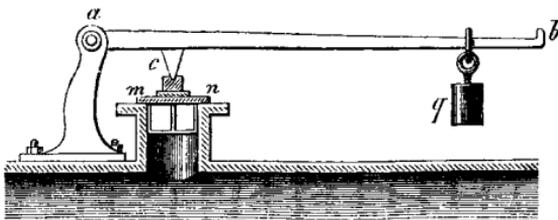
vier  $ab$ , mobile autour de  $a$ , presse par un couteau arrondi  $c$  le milieu de la soupape, et un poids  $q$ , qu'on éloigne à volonté de l'axe  $a$ , sert à régler la tension que la vapeur doit acquérir
