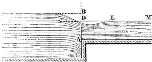
entièrement noyé sur une hauteur déterminée par le prolongement de la surface de pente LM des eaux dans le canal, et l'autre B1) pour lequel l'eau s'écoule librement dans l'air, ainsi qu'il arrive pour les déversoirs sans canal.
