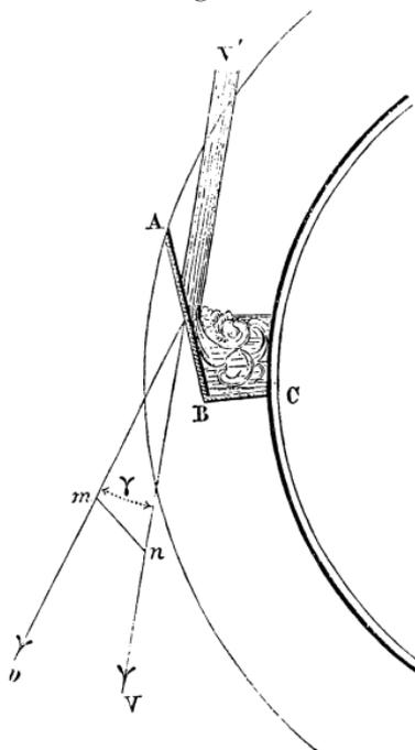
liquide déjà arrivée sur la machine, et qu'il se trouve ensuite contenu dans une espèce de vase ou *à l'auget*, il se produira une nouvelle perte de force vive; après quelques tourbillonnements, tout mouvement relatif sera éteint et le fluide ne conservera que la vitesse propre de l'auget. Dans ce cas, V et v étant toujours la vitesse du filet à son entrée et celle de l'auget, en appelant y l'angle qu'elles font entre elles, la vitesse relative ou perdue sera
