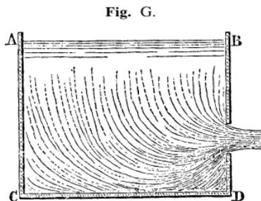
convergent de toutes parts vers l'orifice, pour le cas où il est percé dans une paroi mince et plane et où il se trouve situé à une certaine distance des faces verticales ou du fond du réservoir. Ce cas est d'ailleurs celui qui se rapporte à la plupart
