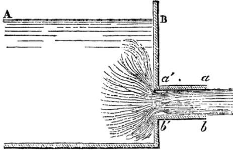
les filets suivent les parois et sortent parallèles, sans contraction apparente, c'est le cas des tuyaux additionnels dont il a été question (23), lorsque l'écoulement s'y fait à gueule-bée. Dans ces circonstances, on a
