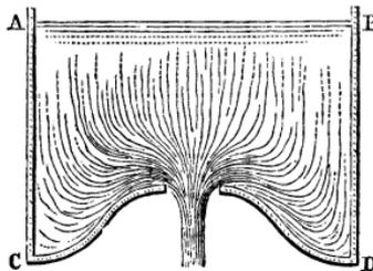
vers l'intérieur, un plus grand nombre de filets peuvent affluer vers l'orifice que dans les *fig. 5* et *6*, et que la contraction doit être ainsi supérieure à celle qui est dans le cas de la *fig. 5*.
