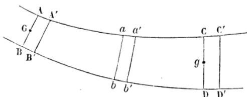
mouillé **ET**, pour vitesse moyenne  $u >$  et dont la distance  $b$  à  $\dots$ , mesurée sur le développement de la directrice du lit, soit représentée par  $l$ , celle de  $CD$  à  $AB$  étant par  $L$ . Nommons, de plus,
