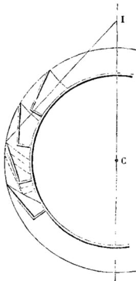
trois ou quatre tâtonnements au plus, on trouvera avec une exactitude suffisante la hauteur du bord de l'auget, où l'eau commence à se déverser, au-dessous de celui où elle a été reçue. Cela fait, on sera en état de calculer le terme  $q'h'$ .
