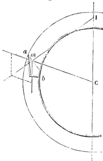
état de mouvement uniforme, il s'ensuit que la force répulsive (\*), qui tend à faire sortir le fluide des augets, passe constamment par le point  $I$ ; ce qui indique, d'après les lois connues de l'équilibre des fluides, que la surface de l'eau dans l'auget sera cylindrique et concentrique à  $I$  dans toutes les positions.
