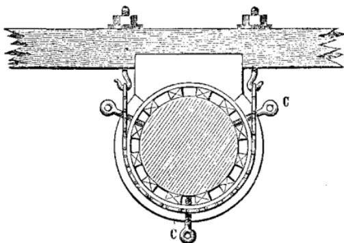
Il ne serait pas difficile de calculer les dimensions du manchon par la condition que le frottement de la bride sur l'arbre, ou, ce qui revient au même, la tension des boulons ne dépassât pas une valeur qu'un ou deux hommes pussent produire facilement à l'aide d'une clef d'écrou de dimension donnée. Nous nous bornerons à dire qu'on peut aisément mesurer sur une partie cylindrique :
