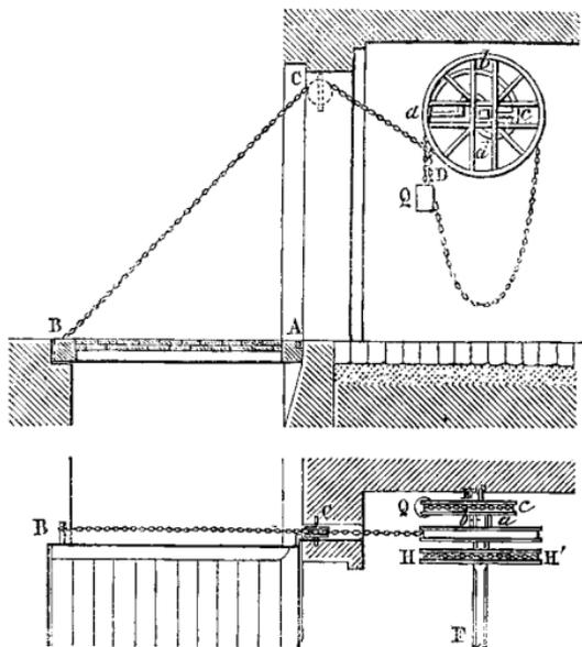
sans fin qui sert à la manœuvre du pont-levis. D'après cette description sommaire, on conçoit facilement que le but de la spirale est de faire varier le bras de levier du contre-poids Q, de façon qu'il fasse constamment équilibre au poids du tablier considéré dans ses diverses positions.
