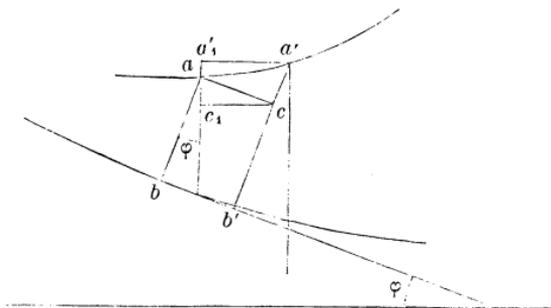
forme avec l'horizontale l'élément  $bb' = dl$  de la directrice du canal; la profondeur  $ab$  du courant au-dessus du point  $b$ , mesurée suivant la perpendiculaire à cette directrice. Par le point  $a$  menons à  $bb'$  la parallèle  $ac$ , rencontrant en  $c$  l'ordonnée  $a'b'$  voisine de  $ab$ , et par le point  $a'$  l'horizontale  $a'a$ , rencontrant en  $a$  la verticale du point  $a$ ; on aura évidemment
