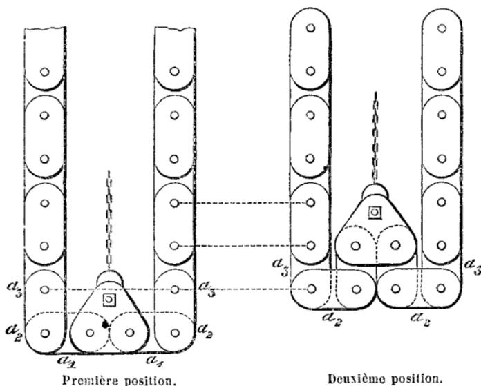
tuation horizontale, et observant que la moitié seulement du poids de ces plaques agit sur F. Considérant ensuite le tablier dans la position où le système de plaques suivant  $a_2 a_2$  est, à son tour, devenu horizontal et où il pèse par la moitié de son poids en F, augmentée du poids des seconds boulons, la valeur correspondante de Q, diminuée de  $Q''$ , donnera précisément cette moitié de poids, etc.
