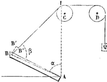
Mais, en appelant  $p$  la composante du poids du tablier agissant en B, laquelle est environ 1500 kilogrammes, et supposant que le point de contact moyen I des poulies et des chaînes soit sur la verticale A des tourillons, on trouve, d'après les considérations mises en usage dans ce qui précède, que la valeur correspondante des grosses chaînes du contre-poids doit être
