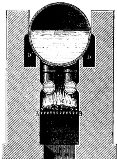
en fonte; deux autres cylindres d'un plus petit diamètre appelés *bouilleurs*, souvent en fonte, mais plus généralement aujourd'hui en tôle de fer et mieux encore en tôle de cuivre, sont placés immédiatement au-dessus du foyer et communiquent avec la chaudière par des tubulures. La flamme circule sous les bouilleurs et la chaudière par un carneau C, passe ensuite dans le carneau D, chauffe le devant de la chaudière, puis se rend par le carneau D' dans la cheminée.
